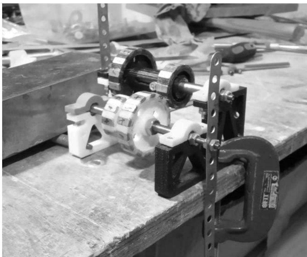
Рис. 2. Маломощная двухступенчатая магнитная передача
