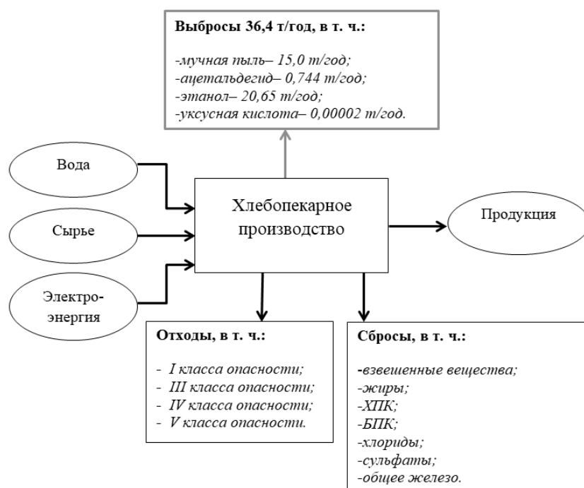
Рис. 3. Обобщенная схема материального баланса воздействия хлебопекарного производства на окружающую среду
