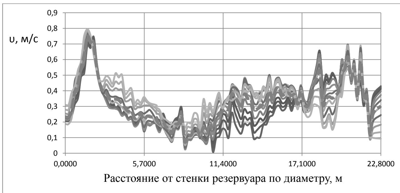
Рис. 1. Скорость нефти на поверхности в резервуаре с Т-образными успокоителями
