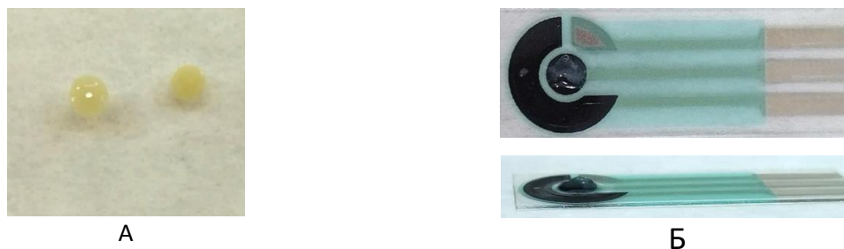
Рис. 1. Сфероиды Fe^{3+} -Alg (А) (объем 10 мкл); Планарная электродная система с нанесенным гидрогелем альгинатом, стабилизированным раствором FeCl_3 (Б).
